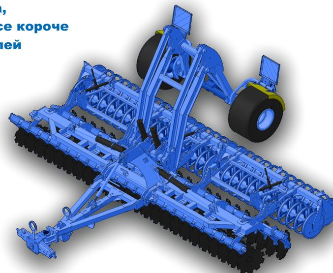
Различия появляются в рабочем положении, при котором колеса складываются по направлению к трактору, а весь вес тележки находится над рабочими элементами компактной дисковой бороны U 693.
