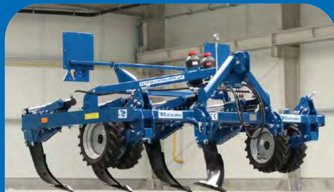
Рабочая ширина глубокорыхлителя U 614 3,0 м (6 зубьев)
