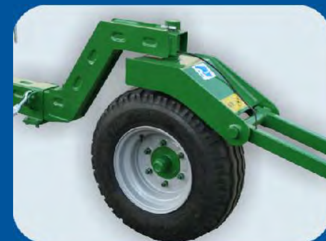
Двухосная тележка Rolmako обеспечивает уникальный комфорт во время перевозки. Ее передняя управляемая ось прекрасно ведет тележку вслед за комбайном (идеально подходит для транспортировки на поля с тяжелым доступом). Малый радиус поворота обеспечивает комфорт использования. Ее надежная конструкция предназначена для большого пробега.
