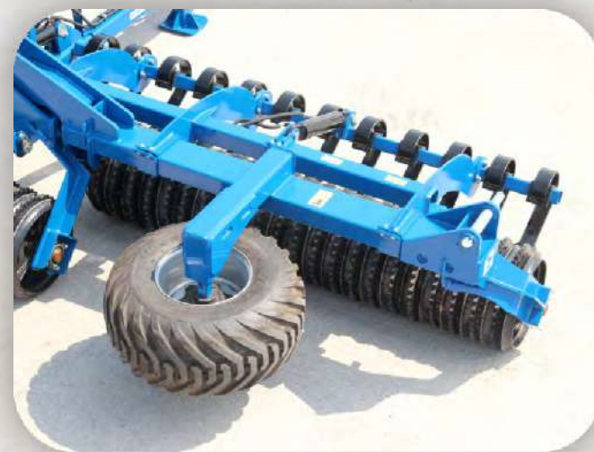
Транспортировочные колеса катка размером 400/60-15,5
