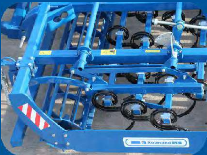
Зубец SU выполнен из пружины 32X12мм, в стандарте имеет дополнительное усиление. Для сбитой и подмокрой почвы советуем использовать отогнутые зубья SU или прямые SA вместо зубьев типа «гусиная лапка».
