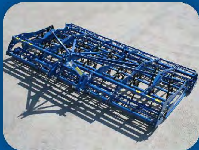
Предпосевные агрегаты нескладные (с жесткой рамой) выпускаются с шириной захвата 3,0 м, 3,5 м и 4,0 м.
