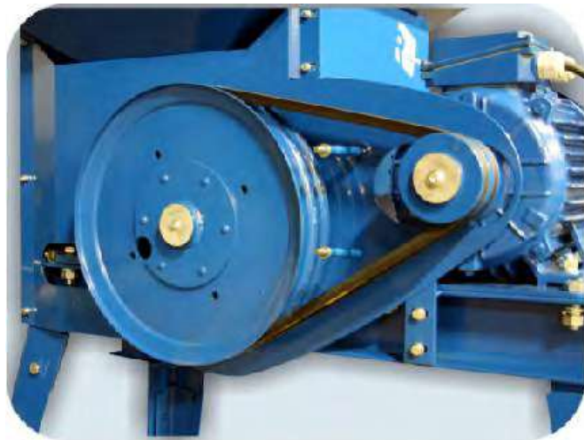
Ременной привод на сплющивающий вал
