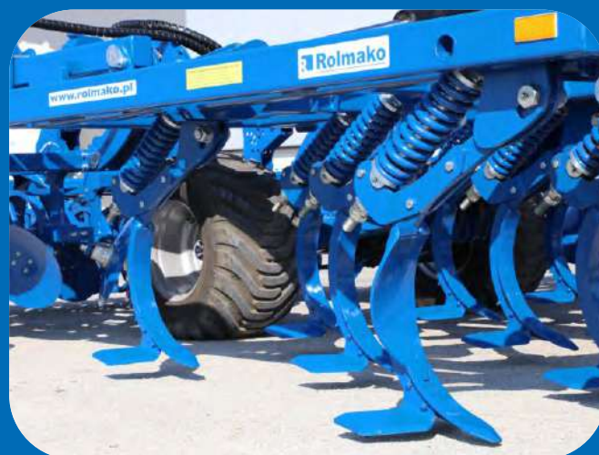
Каждый зуб независимо реагирует на препятствия, а пружина позволяет свести к минимуму силу, возникающую во время столкновения, и быстро возвратится узлом к точно расположенному рабочему положению
