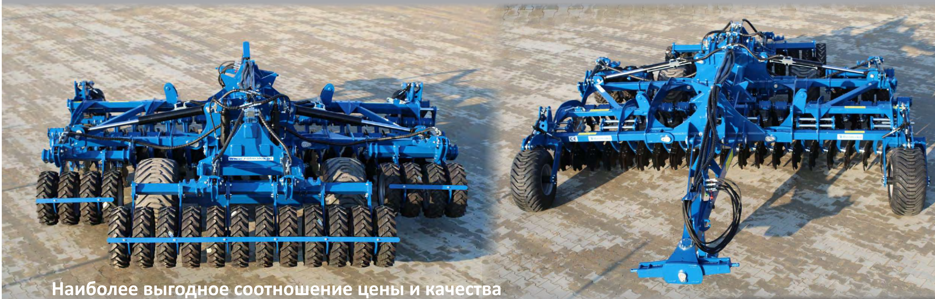
Дисковая борона U 652 с резиновым амортизатором 40 мм х 180 мм и колесным катком
