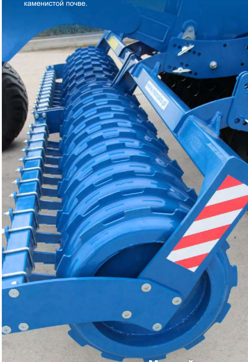
Дисковая борона U 671 standard с транспортной тележкой, расположенной за прикатывающим катком
