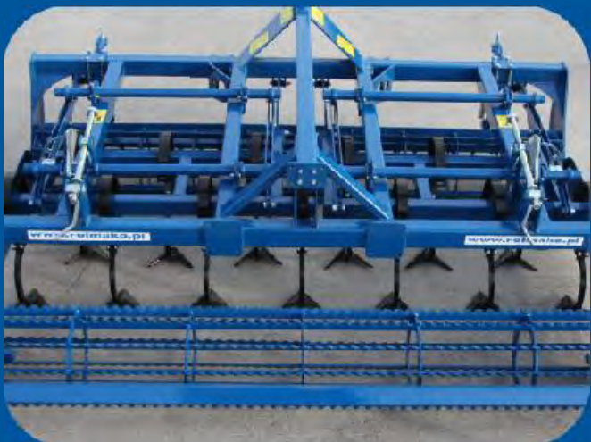
Зубец SU выполнен из пружины 32X12мм, в стандарте имеет дополнительное усиление. Для сбитой и подмокрой почвы советуем использовать отогнутые зубья SU или прямые SA вместо зубьев типа «гусиная лапка».
