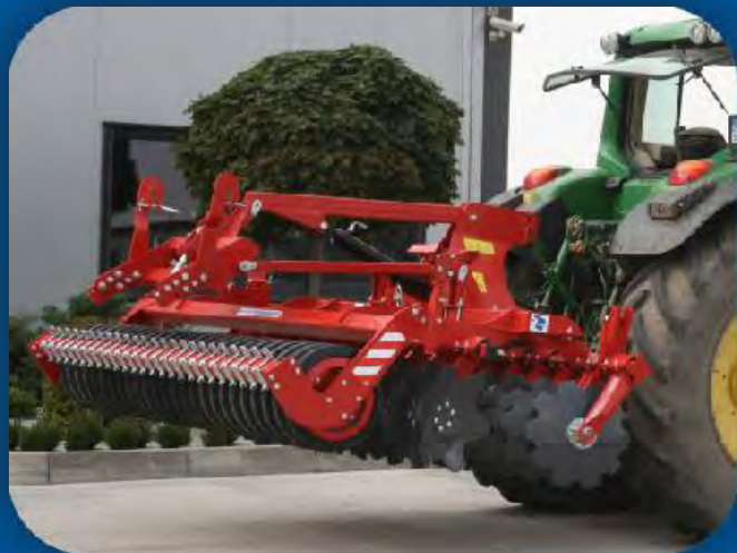
Дисковая борона 3,0 м в навесной версии. Агрегат оснащен резиновым катком и сцепкой к сеялке. В этой конфигурации вес агрегата составляет 1900 кг.
