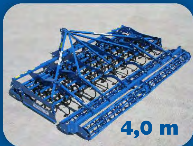
Предпосевные агрегаты нескладные (с жесткой рамой) выпускаются с шириной захвата 3,0 м, 3,5 м и 4,0 м.
