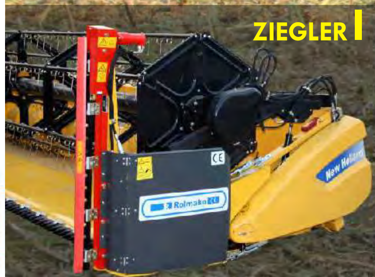
Приставка к комбайну New Holland 6м с гидравлическими косами.
