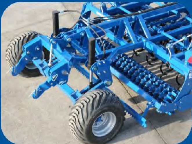
Сцепка для зерновой сеялки или катка Cambridge доступна опционально для прицепных машин с жесткой рамой и складных гидравлически.
