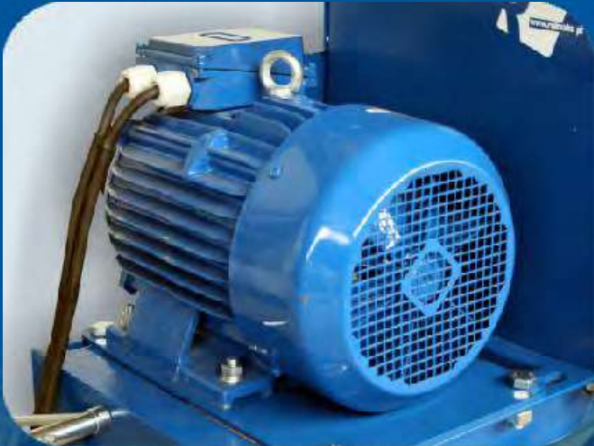
Плющилка зерна приводится в движение мотором мощностью 7,5 кВт
