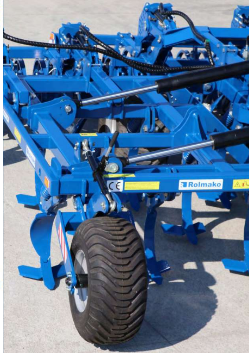
Опорные колеса это очень полезный вариант стабилизации машины во время работы
