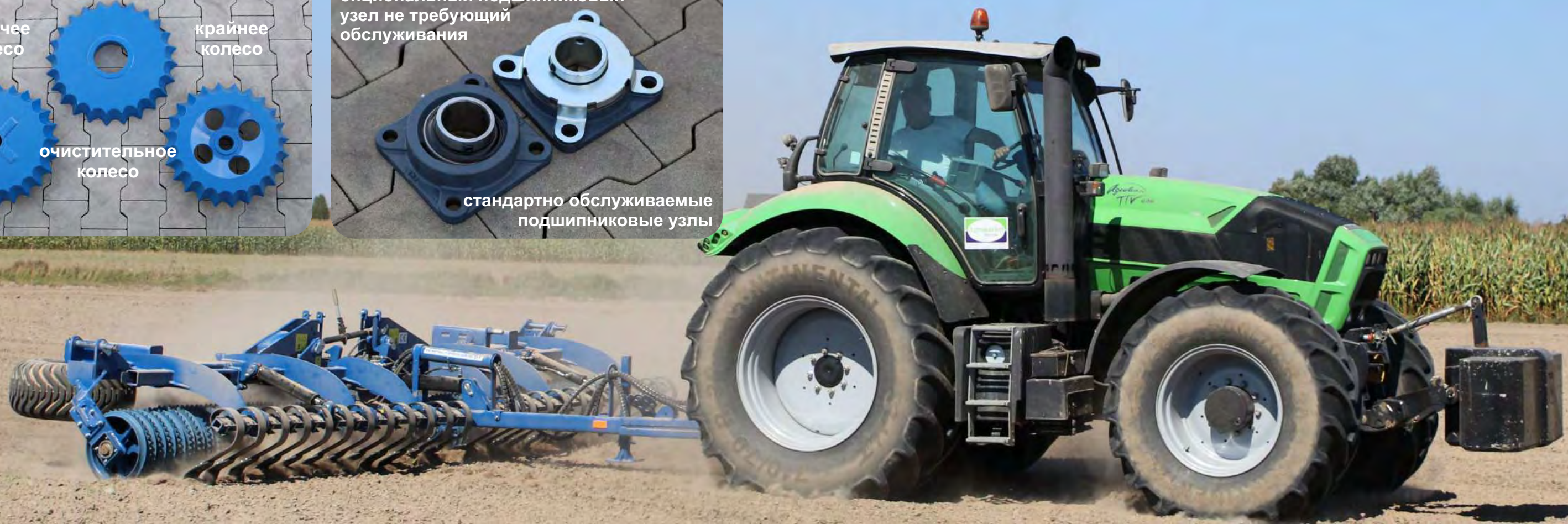
Два варианта подшипников для прикатывающих катков
