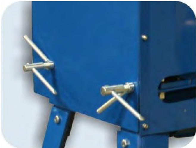
Рычаги регулирующие рабочий зазор
