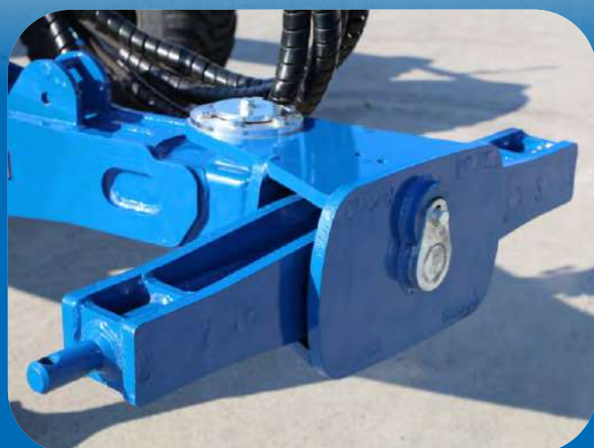
Опорные колеса это очень полезный вариант стабилизации машины во время работы
