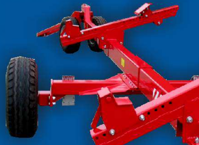
Двухосная тележка Rolmako обеспечивает уникальный комфорт во время перевозки. Ее передняя управляемая ось прекрасно ведет тележку вслед за комбайном (идеально подходит для транспортировки на поля с тяжелым доступом). Малый радиус поворота обеспечивает комфорт использования. Ее надежная конструкция предназначена для большого пробега.
