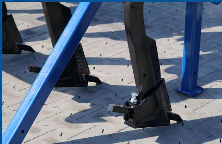
Зуб ATLAS настроен на работу в качестве глубокорыхлителя
